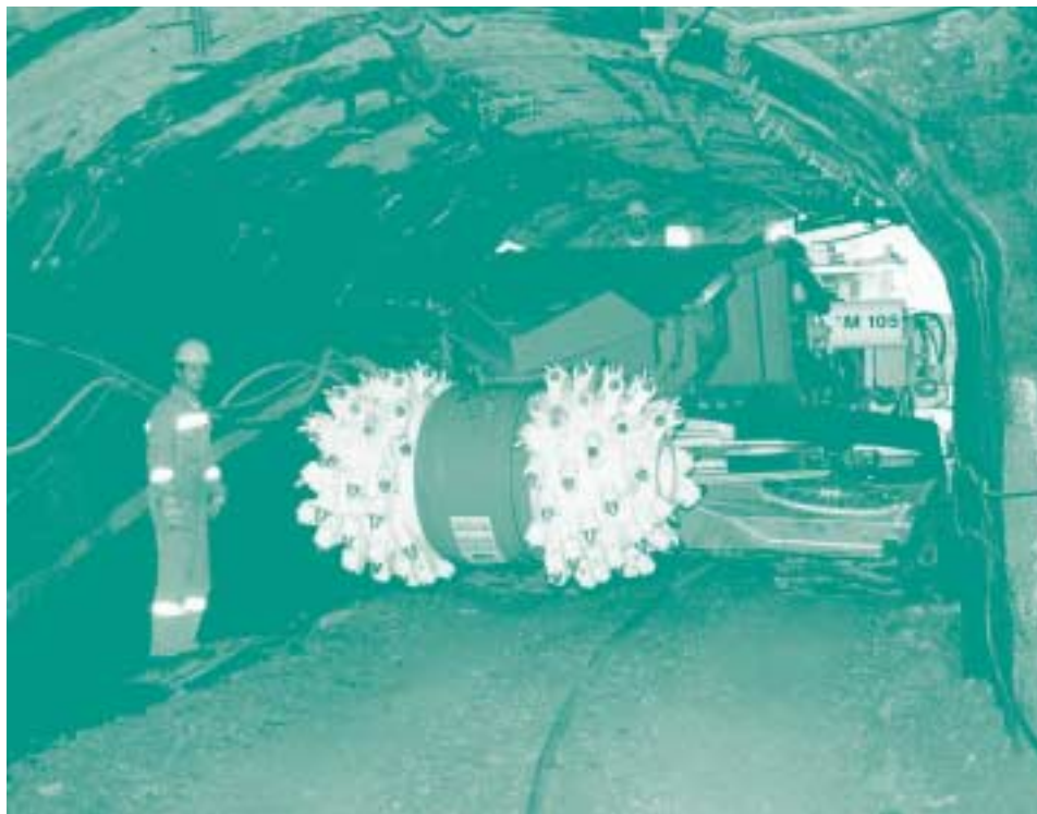
Eine Teilschnittmaschine im festen Gebirge
