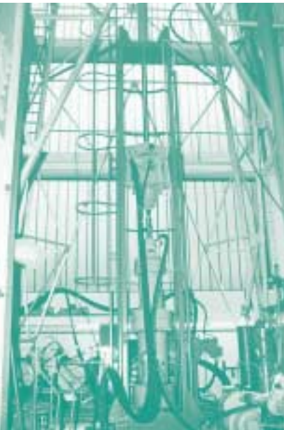
Intensive Versuche mit einer eigens eingerichteten Laborbohranlage (Fotos: Institut für Tiefbohrtechnik)
