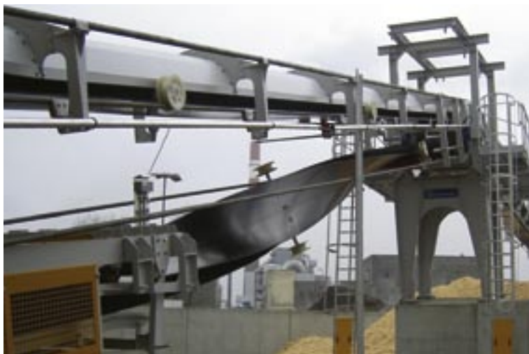
In Lenzing (Oberösterreich) wurde ein RopeCon zur Förderung von Hackschnitzeln von der Firma Doppelmayr installiert. Dieses Gurtfördersystem ermöglicht es der Industrie, kostengünstiger und umweltschonender zu arbeiten.
