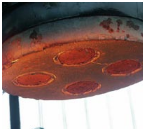
Prof. Anton Mayer entwickelte einen brandbeständigen Beton, der einen Schmelzpunkt von über 1400 Grad Celsius aufweist. Versuche, wie die in den Bildern gezeigten Labortests, bestätigten die Brandbeständigkeit.
