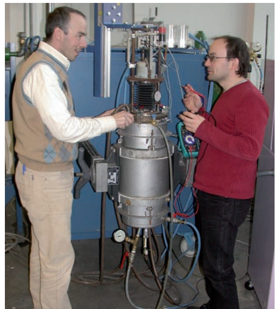
Dipl.-Ing. Jörg Korp (links) und Dipl.-Ing. Andreas Schmid vor ihrer entwickelten Apparatur zur Temperaturmessung der Schlacken.
