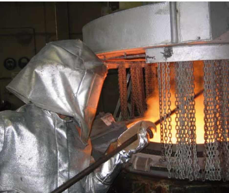
Einschmelzen von metallhaltigen Reststoffen in einem Elektrolichtbogenofen.
