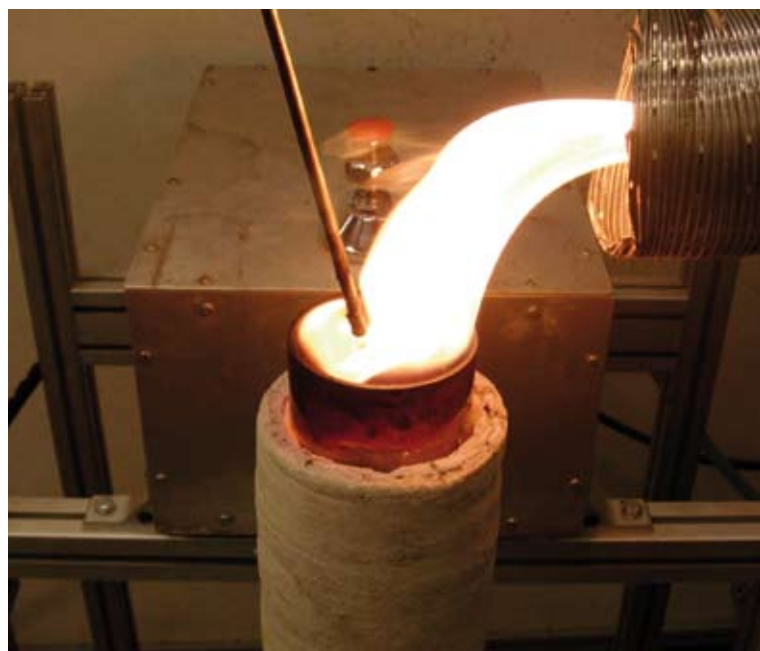
Ausbrand des heißen Reduktionsgases bei Luftkontakt.
