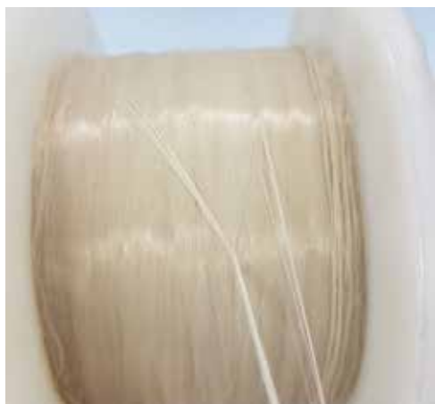
Die gewonnenen Fasern können wieder für den Spinnprozess verwendet werden.
