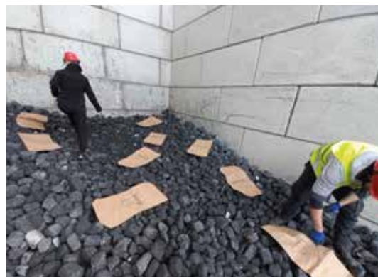
Die Wissenschaftler*innen bereiten derzeit Proben des verwendeten Feuerfestmaterials aus der Stahl- und Zementherstellung vor, um eine Grundlage für die anstehenden Forschungsaktivitäten zu schaffen.
