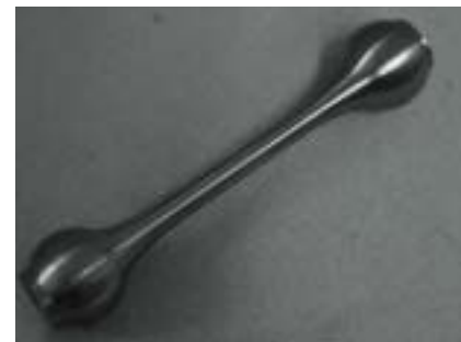
Zugprobe für höchstfeste Werkzeugstähle
