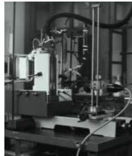
Laser-Sonde und Versuchszelle (Bilder: Institut für NE-Metallurgie)
