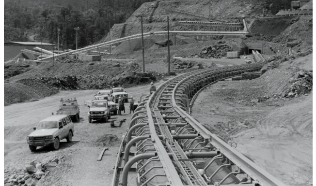
Horizontalkurven sind mit dem vom Fördertechnik-Institut entwickelten Gurtförderer kein Problem mehr.
