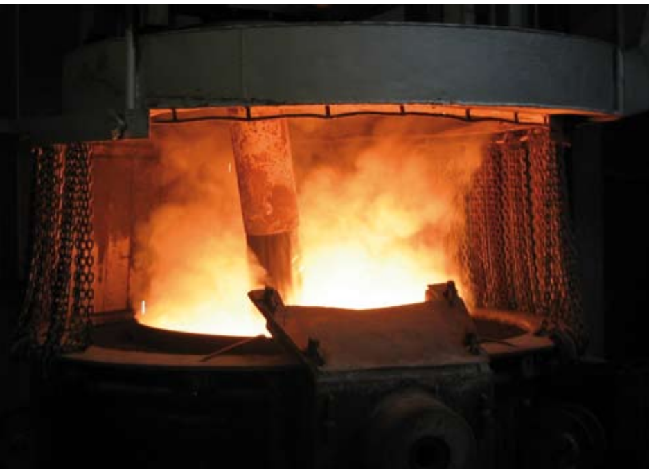
Einschmelzen von refraktärmetallhaltigen Reststoffen in einem Elektrolichtbogenofen.
