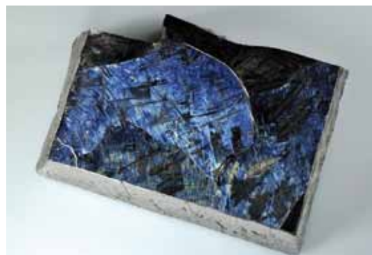
Hochreines (99,999 %) Titan mit opaleszierender Oberfläche
