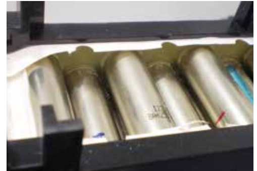
Aufbau einer Traktionsbatterie aus Rundzellen
