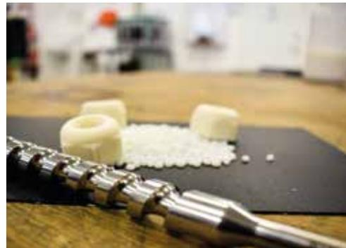
*Mit der neuen Technologie können Bauteile in industriellem Maßstab hergestellt werden, die einerseits über eine individuelle Geometrie wie im 3-D-Druck verfügen, andererseits aber auch so beanspruchbar sind wie Bauteile aus dem Spritzgussprozess.*
