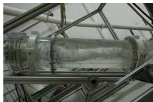
Mithilfe des Zentrifugalkraftscheiden können Altkunststoffe aus gemischten Abfallfraktionen abgetrennt werden.
