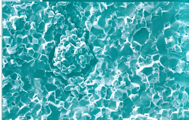
Bild: Bruchausgang in Aluminiumoxid Bild Vorderseite: Aluminiumoxid-Bruchfläche Bild Rückseite: Rasterelektronenmikroskopische Aufnahme einer Siliziumnitrid-Bruchfläche.
