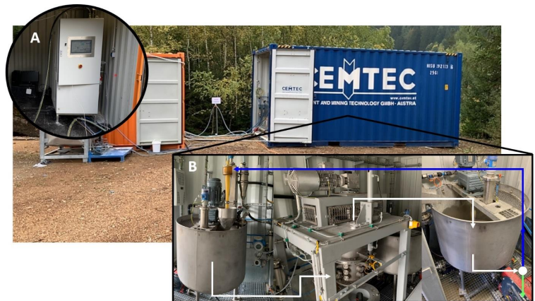
Abbildung 1 Containermühle des Lehrstuhls für Aufbereitung und Veredlung; Bild A: Blick in den CEOPS-Container (orange Container; Bild B: Stellt den Aufbau der Mühle im Container dar. Anhand der weißen Pfeile ist der Trübbefluss vom Aufgabetank, durch die Mühle, in den Produkttank veranschaulicht. Durch Verschaltungen am Produkttank, kann die Mühle im Kreislauf über ein Hydrozyklon (blauer Pfeil) oder im Durchlauf (grüner Pfeil) betrieben werden
